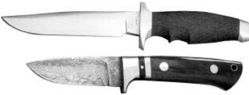
Рис. 3. Упоры — традиционный элемент европейских ножей
