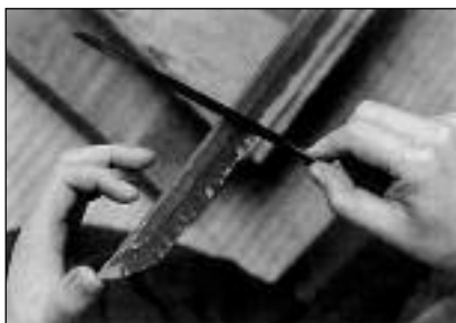
Нанесение глиняной обмазки на клинок перед закаливанием в воде (шпателем наносятся ребра из глины — аси)
