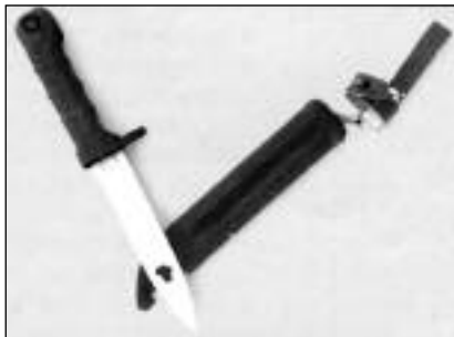
Штык-нож к АК-74 (обр. 1989 г.) с ножнами в положении для перекусывания колючей проволоки
