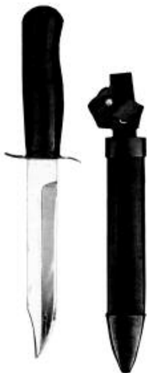
Нож армейский «НР» образца 1940 г. Длина клинка 150 мм, ширина 22 мм, толщина ок. 3 мм, общая длина 263 мм
