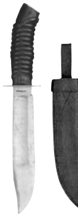
Нож армейский «канадского» типа. Общая длина 295 мм. Длина клинка 175 мм, ширина 28 мм. Широкий дол на каждой стороне клинка, эбонитовая рукоятка
