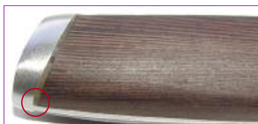
Накладки посажены на клей (предположим), что позволяет в той или иной степени компенсировать разницу в форме (качестве обработки) сопрягаемых поверхностей (погрешности производства)
