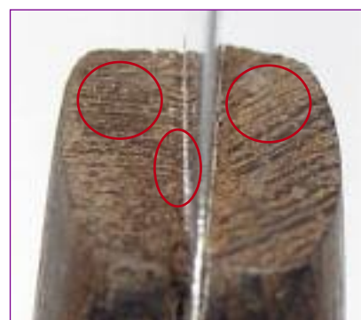
При пристальном взгляде (при увеличении) обращает на себя внимание наличие тонкой пластины, подклинивающей накладку. Торец накладок имеет следы выкрашивания древесины, что демонстрирует как качество самой древесины, так и качество ее обработки...
