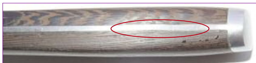
Очевидных следов сварки полосы и затыльника нет. Предположим, что металлическая часть ножа изготовлена из цельного куска металла. Каким именно образом убирался лишний металл, если в указанном месте ширина полосы так пляшет? Явно не на станке с ЧПУ... Неужели напильником???
