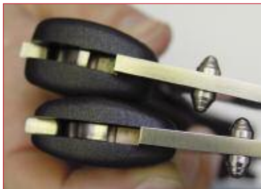
Слабое место конструкции фиксатора проявляет себя в зависимости от величины допусков деталей механизма
