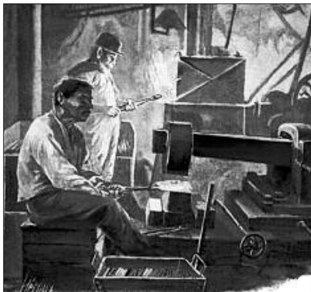
Отковывание клинков при помощи хвостового молота
