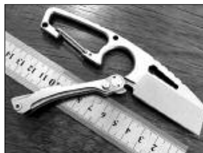
Hot Cutter («горячий резец») — карманный тактический складной нож из порошковой стали CPM-S35VN
