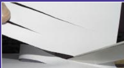
Качество РК ножа в ходе теста периодически контролировалось «строганием» листов бумаги
