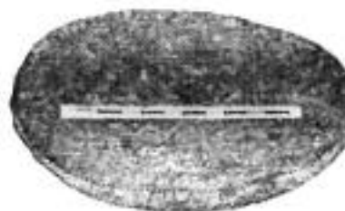
Фиг. 10. Диск железа (полуфабрикат)
