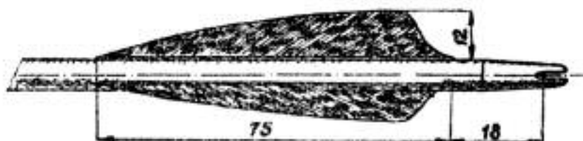
Рис. 29. Оперение с кончиком (размеры в мм)
