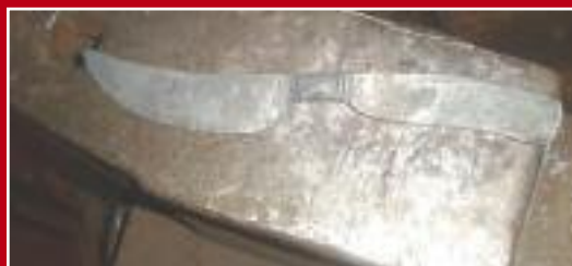
Из полученной заготовки ковкой формируем будущий нож
