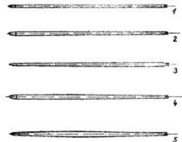
Рис. 20. Различные формы стрел: 1 — цилиндрическая; 2 — коническая, суживающаяся к пятке; 3 — коническая, суживающаяся к острию; 4 — цилиндрическо-коническая; 5 — сигарообразная
