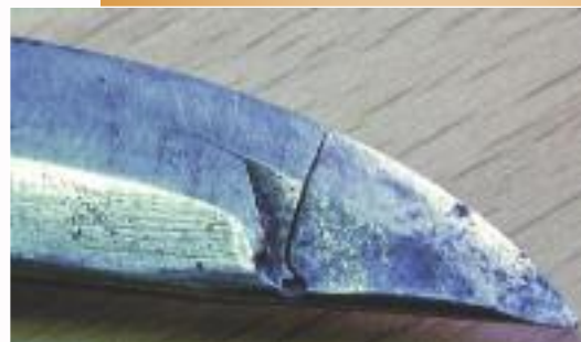
Клинок может быть поврежден на стыке ламината в результате длительной интенсивной эксплуатации
