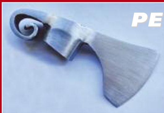
Топорик. Перекованная кирка каменщика
