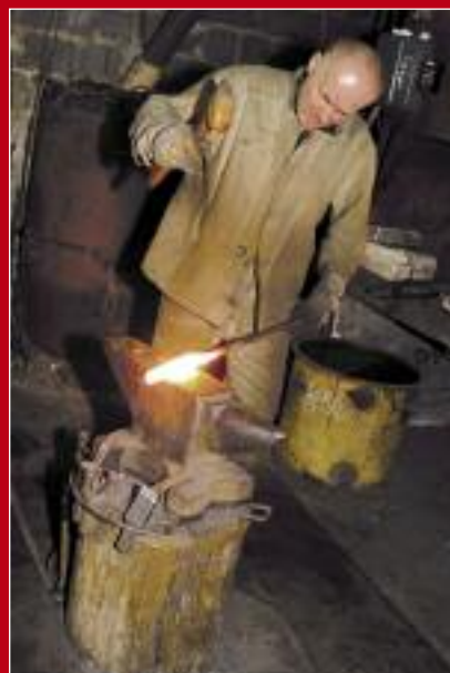
Кузнечная сварка пакета осуществляется вручную
