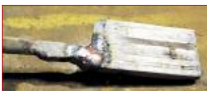
Приготовленный для кузнечной сварки пакет
