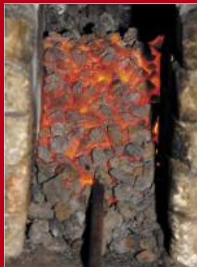
Нагрев пакета при выключенном дутье
