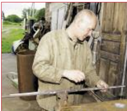
Разметка полосы на необходимое количество пластин для нового пакета
