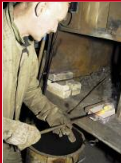
Покрывание пакета флюсом
