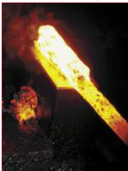
Новый цикл кузнечной сварки пакета
