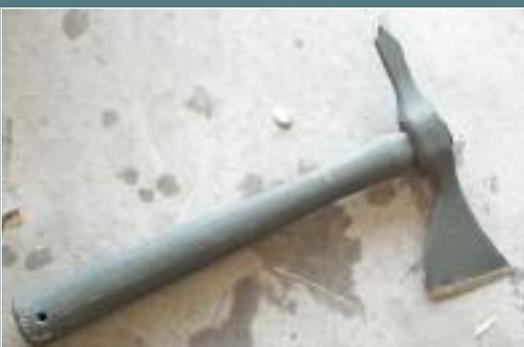
Реплика томагавка ЛаГана времен вьетнамской кампании производства Cold Steel. Лезвие из стали 1055 с зонной закалкой
