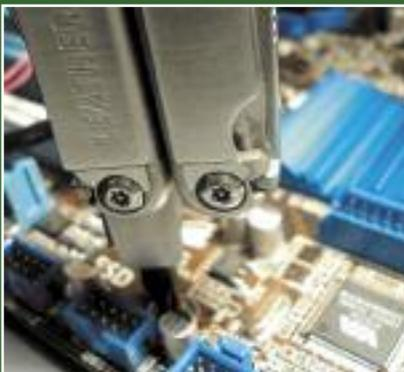
губок, для этого предусмотрены несколько вариантов расположения шарнира в специальных пазах. Процесс перестановки довольно прост: развели рукоятки и переставляем в необходимое углубление. Кроме степени сжатия это также позволяет регулировать величину расстояния между гранями губок, то есть расширяет диапазон размеров захватываемых деталей.
