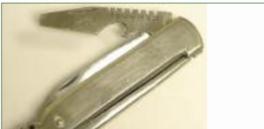
Французский специализированный мультитул электрика, изготовленный из американской инструментальной нержавеющей стали Seaboard Steel фирмой E. Behrman в 1950-х годах
