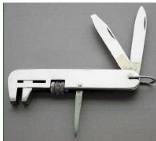
Мультитул фирмы Hoffritz N.Y. на основе трубного ключа
