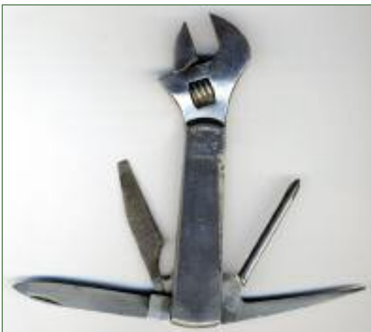
Мультитул из нержавеющей стали Seaboard Steel на базе разводного ключа под названием Pocket Auto Kit («Карманный авто комплект»)
