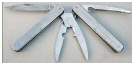
Мультитул из Золингена, запатентованный в 1964 году в Мюнхене и выпускаемый фирмой A. Bauermann & Co. под названием Pocket fishermen's tool («Карманный инструмент рыбака»)
