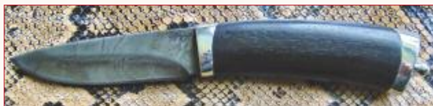
Фото 15. Когда клей затвердел, шлифую и полирую рукоять в сборе
