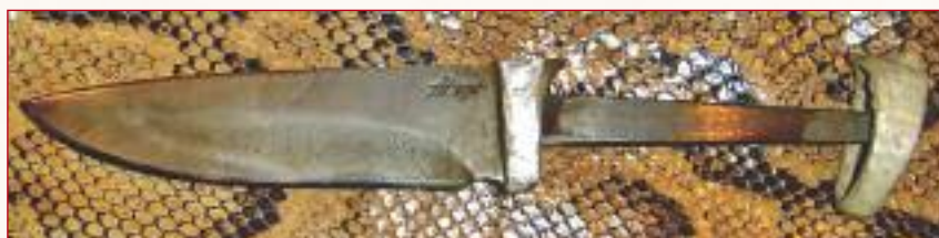
Фото 11. Начерно собираю на хвостовик полугарду и навершие рукояти, чтобы разметить угол врезки к дереву
