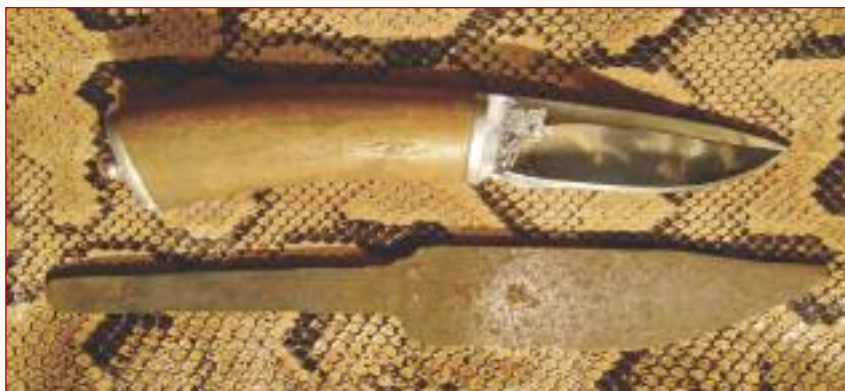
Фото 1. Заготовка торцового дамаска (кузнец Михаил Красин)
