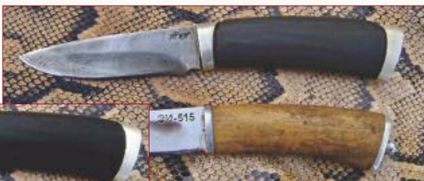
Фото 13. Начерно собираю рукоять на хвостовик, сравниваю ее с образцом
