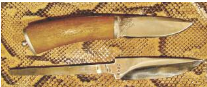
Фото 6. С обратной стороны клинка набиваю год изготовления
