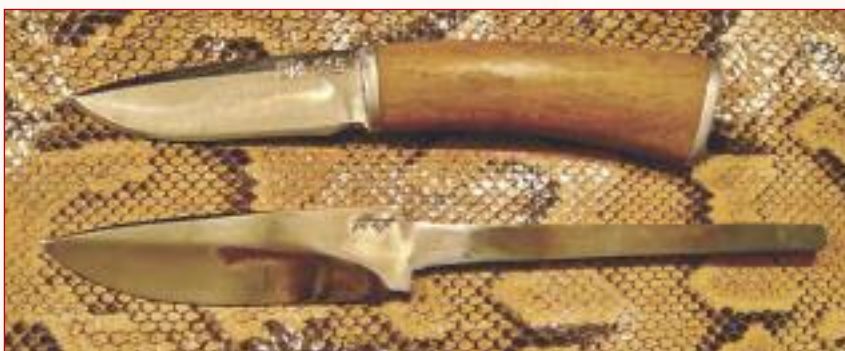
Фото 5. После шлифовки на пятке клинка ставлю свое клеймо
