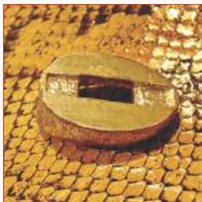
Фото 10. Делаю в полугарде отверстие под хвостовик и стихелем вырезаю углубление (потай) под пятку клинка для увеличения жесткости
