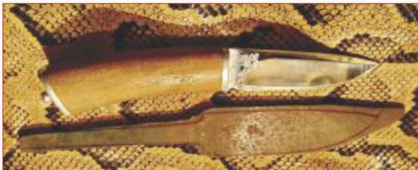
Фото 2. Используя оригинальный нож как шаблон, вычерчиваю контуры клинка на заготовке
