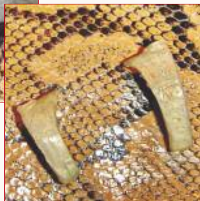
Фото 9. Отпиливаю литники и шлифую отливки
