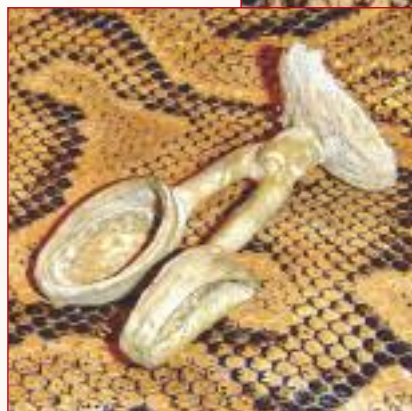
Фото 8. Делаю отливки из серебра для полугарды и навершия рукояти
