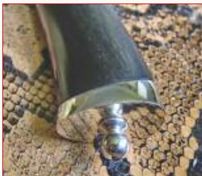
Фото 16. Шпенек под фиксацию в ножнах вкручиваю на резьбу в наверхие рукояти (сам шпенек выточил с помощью электродрели, штихеля, надфиля и наждачной бумаги)
