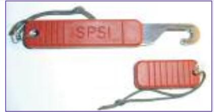
Крюки-стропорезы (Strap Cutter) пришли на замену традиционным ножам уже в 1960-х
