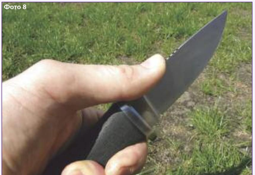
Для сравнения, хоть она и очень хорошо известна, ATS-34. Высокоуглеродистая хромистая подшипниковая сталь японского производства (Hitachi Metals). Данная сталь пользуется широкой популярностью с конца 80-х гг. прошлого века при изготовлении клинков дорогих серийных и авторских моделей.
