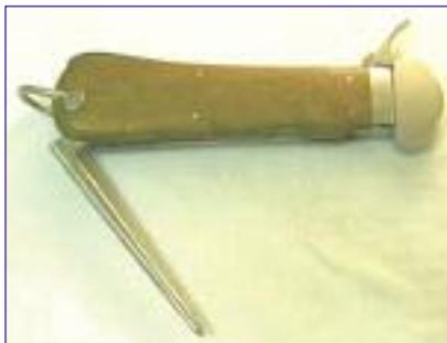
подобные ножи принято именовать «гравитационные» или «инерционные». Корпус ножа представлял собой прямоугольный коробчатый пенал с направляющим пазом, внутри которого и передвигался клинок за счет ускоренного движения руки или просто под действием силы тяжести. Фиксация клинка в крайних положениях (открытом и закрытом) производилась пружиной, оснащенной флажковым рычагом.
