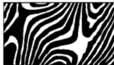
Рис. 2. Узор дамасской стали (сварочная сталь), увеличено в 8,5 раз, элементы узора повторяются
