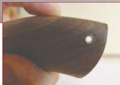
Ореховая рукоятка ножа достаточно эргономична и отличается высокой травмобезопасностью; втулка отверстия для темляка сделана не очень качественно
