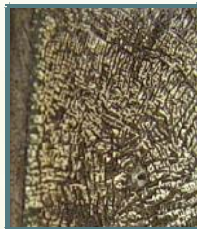
Фото 6 Візерунок з золотавим відблиском, вуглецю — 3,1%
