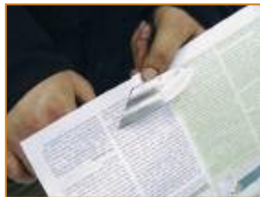
Контроль состояния заточки резом по газетной бумаге
