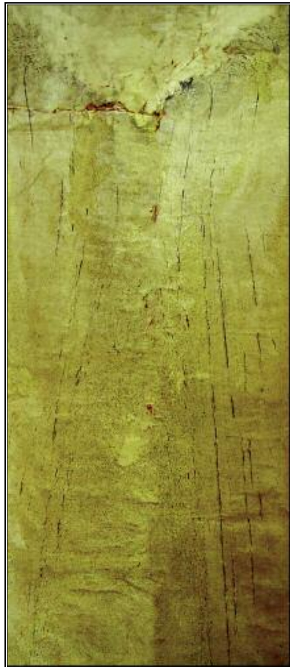
Мал. 3. Відбиток по Бауману на зливку спокійної сталі
