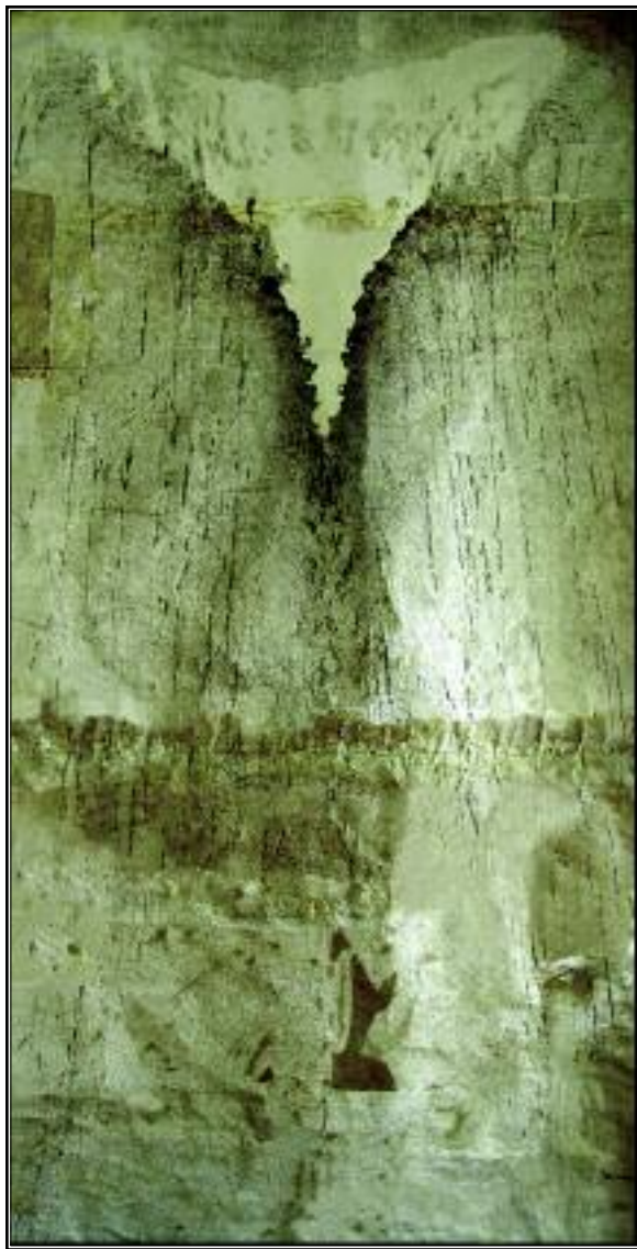
Мал. 5. Відбиток по Бауману на зливку спокійної сталі
