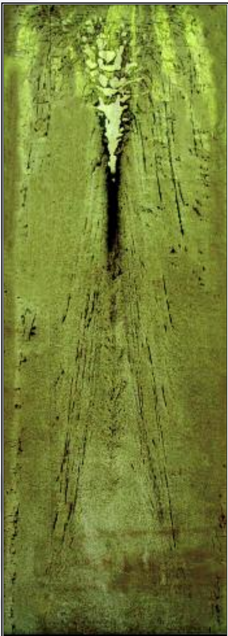
Мал. 4. Відбиток по Бауману на зливку киплячої сталі
