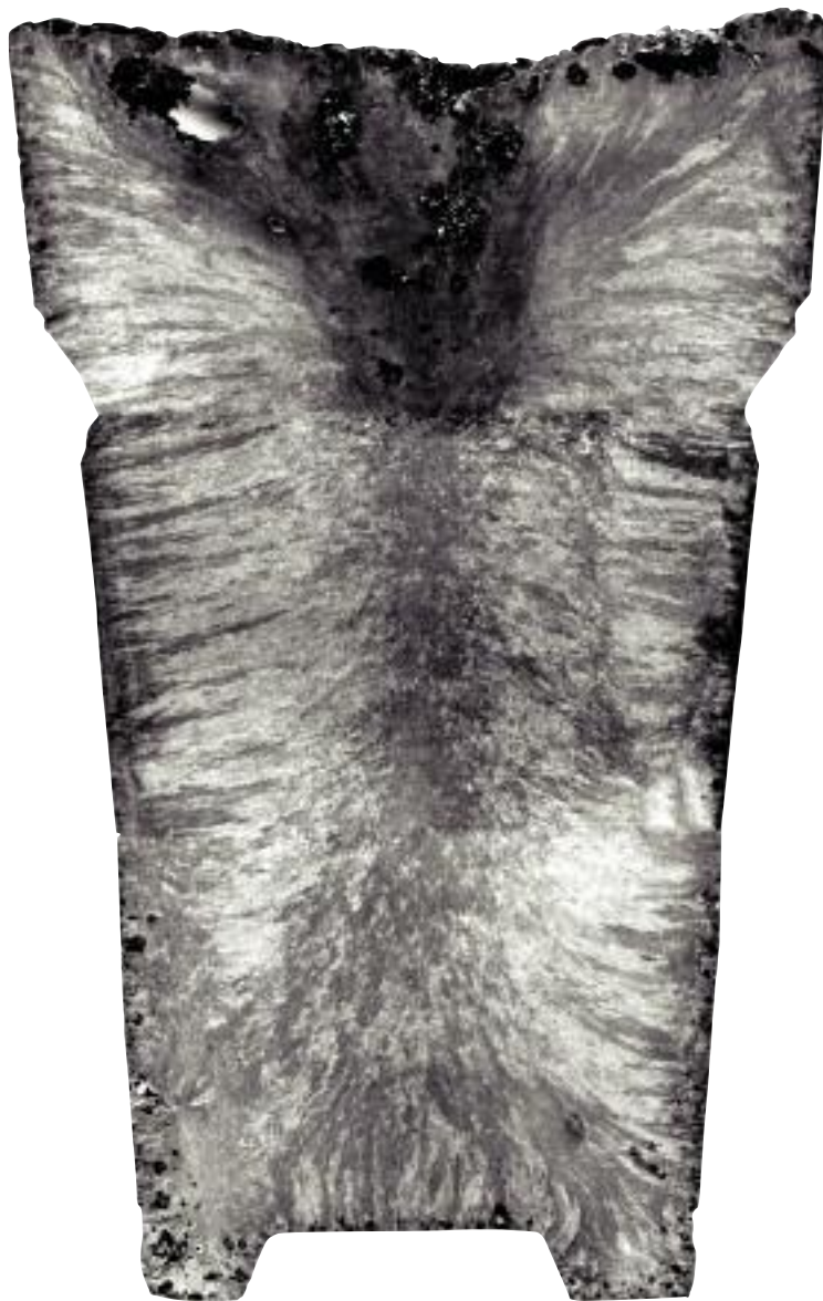
Мал. 2. Кристалітна структура зливка булатної сталі з кількістю вуглецю 2,4 %
